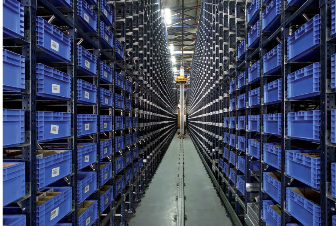
DOBOZOS AUTOMATA RAKTÁR. 24 órás terhelhetőség és automatizált munkafolyamatok jellemzik a rendszert. Tervezhetjük saját nyilvántartó rendszerrel, de egyszerűen illeszthető a már meglévő vállalatirányítási rendszerbe is.
