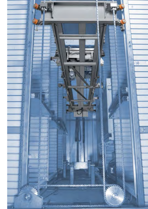
Az egyedi pozicionáló lift biztosítja a függőleges mozgást.
