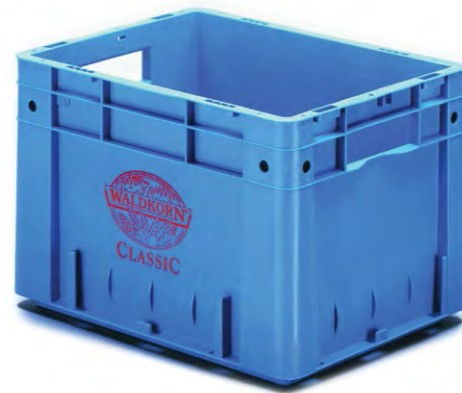
A rendkívül ellenálló, sav- és lúgálló polipropilén alapanyagú termékeink -20 °C-tól +90°C-ig használhatók. Jól illeszthetők az 1200x800 mm-es és 800x600 mm-es raklapokhoz. Fontos kiegészítőjük az áru keveredését meggátló elválasztó fésű vagy betétdoboz. A többféle színben készülő dobozokon címketartó található, de melegsajtólással feliratot is elhelyezhetünk rajtuk.
