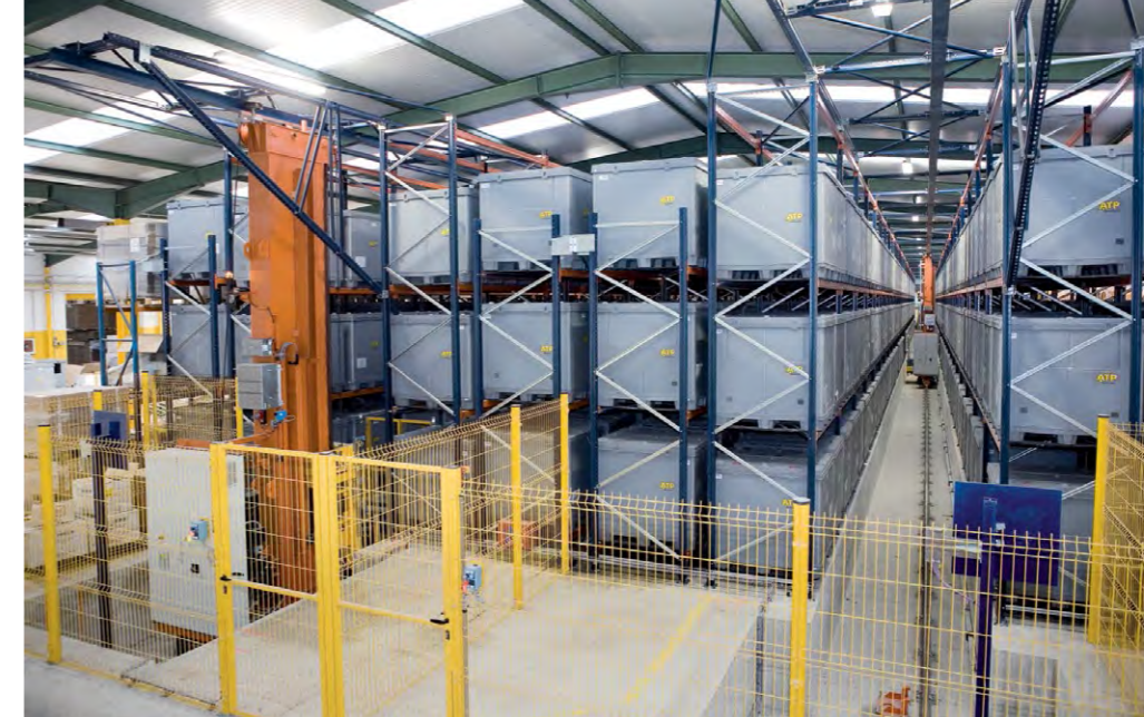
A RAKLAPOS AUTOMATA RAKTÁRBAN a hagyományos, targoncás megoldásokhoz képest háromszor gyorsabb rakatkezelés érhető el. A felrakógépek 30 méternél is magasabbra tervezhetők.
