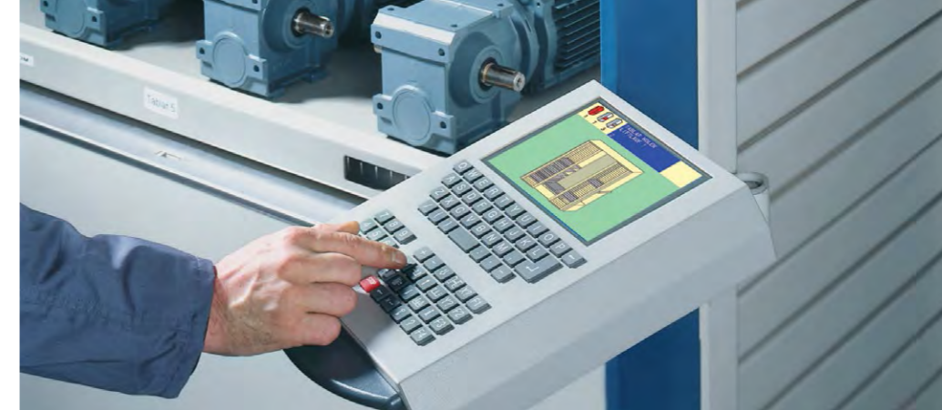
A Lean-Lift ki- és betárolási pontjánál elhelyezett vezérlő konzol az ergonómiai szempontoknak is megfelel.
